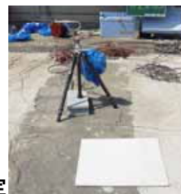
図-12 濾紙を用いた物質伝達率の測定
