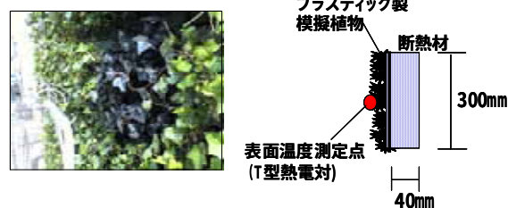
図-5 SAT計の測定と測定項目・測定点
