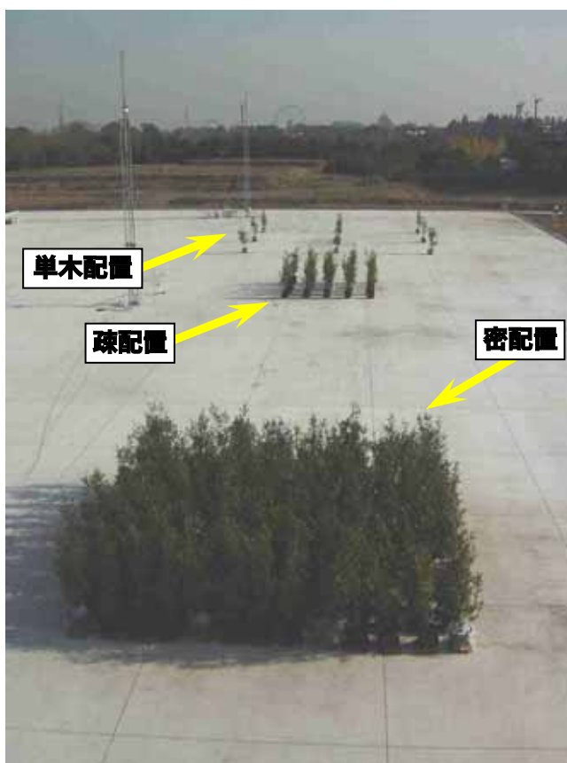
図 7. ポット植栽を用いたオアシス効果の野外実験—植栽密度による蒸散量の違い 4)
